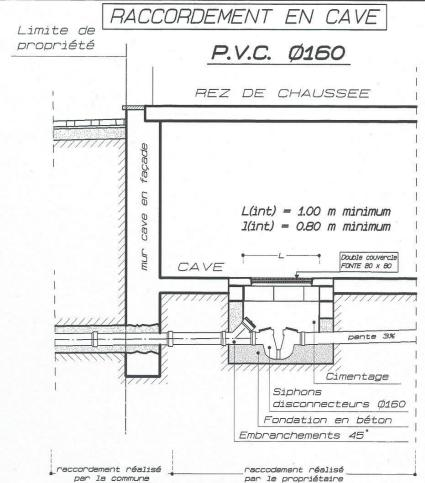
NB : Pour les chambres réalisées dans le terrain, les anneaux béton norme BENOR 🛭 1,00 sont autorisés.
